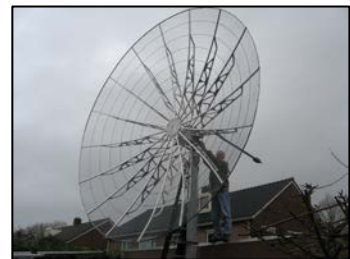
Figure 1 : télescope RF HamDesign de 4.5m de diamètre.
